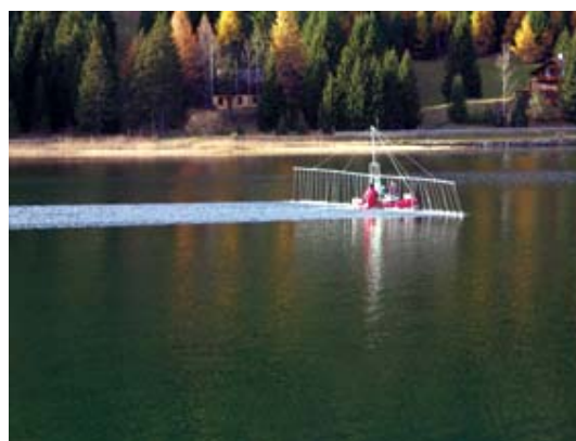
Traitement du lac de Heidsee en Suisse au moyen d'une barque équipée de rampes d'épandage.
